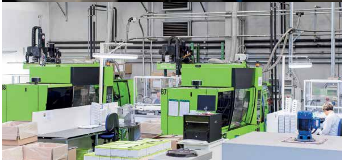
Nel reparto di stampaggio operano alcune macchine a iniezione a tecnologia compatta senza colonne Engel
