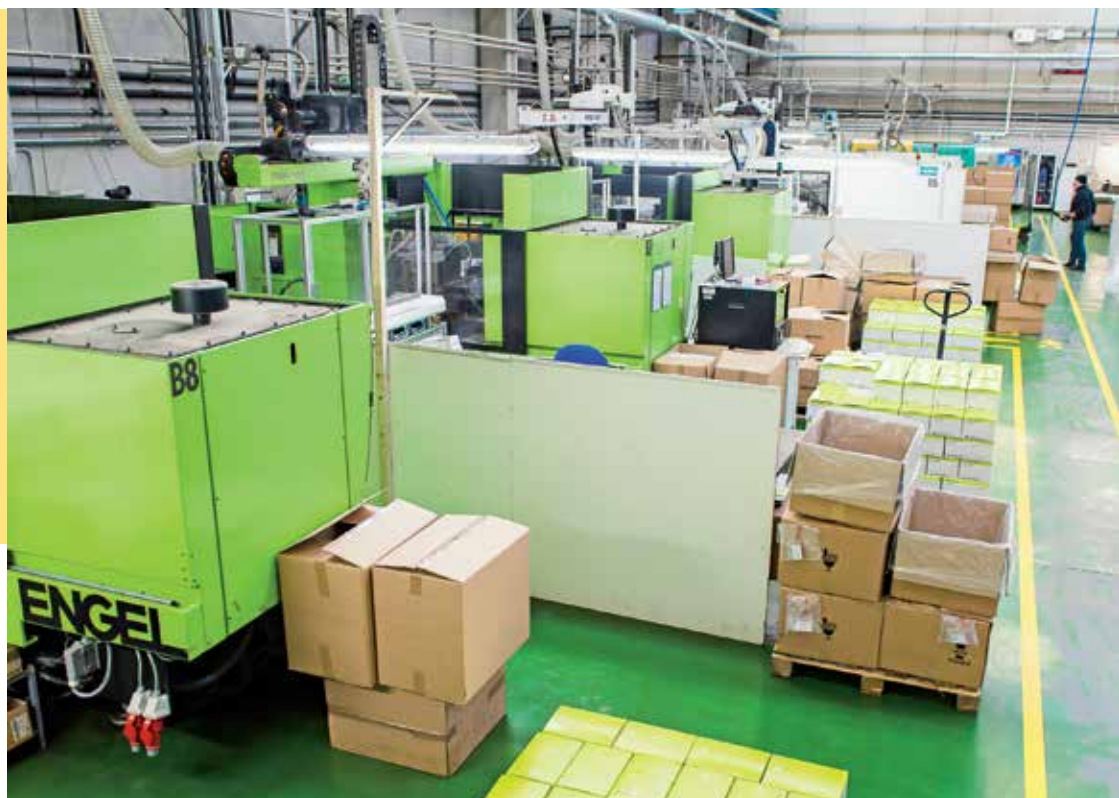
Particolare del reparto di stampaggio a iniezione
