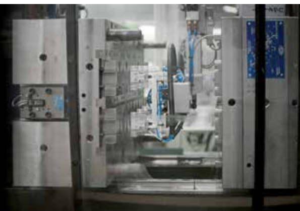
Particolari di un'isola di lavoro automatizzata per la produzione di parti per il comparto medicale
